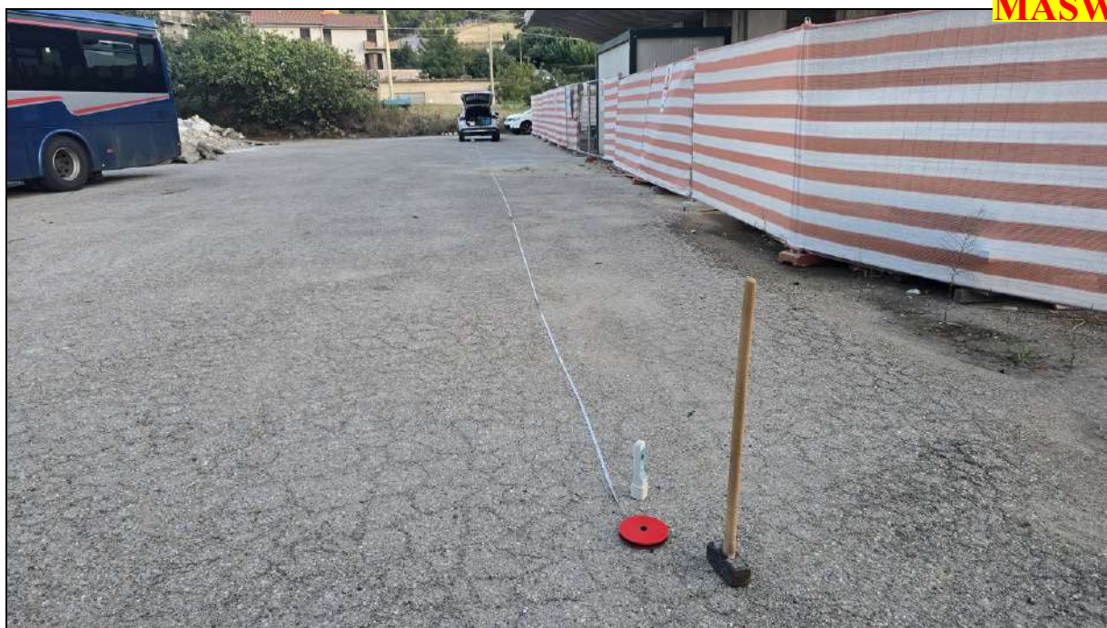
Postazione dell'acquisizione MASW presso il sito di interesse
